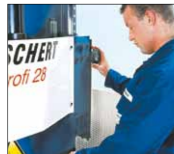
Presstiefe unter Druck einstellbar
