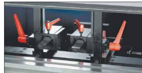
Seitlich und höhenverstellbare Tiefenanschlüge
