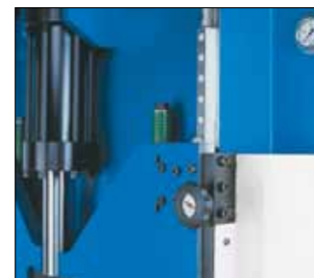
Ein oder zwei 28 Tonnen Kraftzylinder
