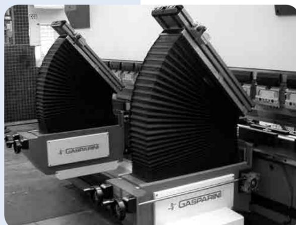
X-PRESS-Pressen können mit einer breiten Auswahl an Hinteranschlügen für die unterschiedlichsten Produktionsanforderungen ausgestattet werden. Die Baureihen **RPS**, **RPL** und **RPG** zeichnen sich durch ihre Robustheit, Genauigkeit und Wiederholbarkeit aus.
