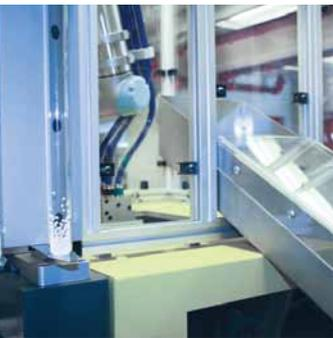
**Der Roboter ist sicher auf der Spritzgussmaschine montiert und kann sich selbst über der Form in Position bringen und die Kunststoffelemente hochziehen. Dies geschieht mithilfe eines speziell entwickelten Vakuumsystems, das gewährleistet, dass empfindliche Elemente nicht beschädigt werden.**
