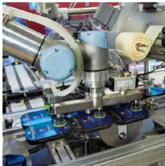
Früher fand der gesamte Verpackungsprozess der Tabaksbeutel in Dosen manuell statt. Jetzt erledigt eine Einrichtung mit Robotern und anderen Geräten die Teile des Prozesses, die für die Mitarbeiter belastend sein können.
