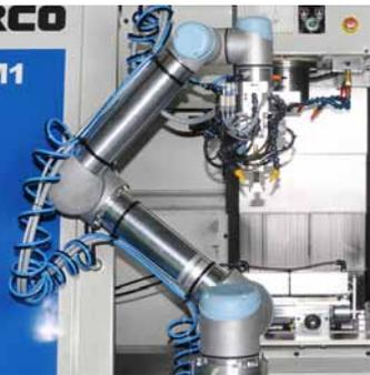
**Der Roboter öffnet beide Türen, legt den Rohling ein, spannt ihn in dem Schraubstock der Maschine fest, nimmt ihn nach Ende des Fräsvorgangs wieder heraus und legt ihn zur Seite.**
