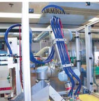
**Oticon verwendet den Roboter auch für eine andere Aufgabe in der Gießerei, bei der das Saugwerkzeug durch ein pneumatisches Greifwerkzeug ersetzt wird, das verwendet wird, um komplexere Gussteile zu handhaben. Der Roboter arbeitet in Zyklen von vier bis sieben Sekunden.**
