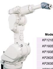
Lackierroboter mit ATEX Spezifizierung zur Realisierung von kompakten Lackierzellen bis hin zu großen Lackierstraßen. Die spezielle Handgelenkskonstruktion ermöglicht eine interne Medienführung – "Hollow Wrist".
