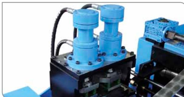
Optional - Hydraulische Ausklinkeinheit
